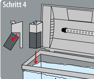
Lesen Sie zuerst die Aqua-Flow Gebrauchsanleitung. Installieren Sie den AquaFlow Filter in das Aquarium. Der Filter sorgt dafür, dass das Wasser frisch bleibt. Reinigen Sie die Kartusche wöchentlich. Nehmen Sie die Kartusche heraus und spülen Sie diese mit Leitungswasser ab. Die Kartusche enthält Kohle, die schädliche Stoffe aus dem Wasser absorbiert, darum müssen Sie die Kartusche monatlich austauschen, um eine gute Wirkung zu erzielen.
