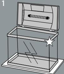
Plaats het aquarium op een vlak, glad, horizontaal en voldoende belastbaar oppervlak. Plaats het aquarium niet op elektrische apparaten of op meubels met watergevoelige oppervlakken. Let op het totale gewicht van het ingericht en met water gevuld aquarium (Start 20: ± 25 kg, Start 30: ± 35 kg, Start 50: ± 55 kg, Start 70: ± 90 kg, Start 100: ± 110 kg, Start 150: ± 170 kg).
