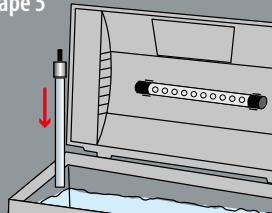
Pour les poissons tropicaux vous devez ajouter un chauffage. Un chauffage adapté est inclus dans le Kit tropical, placez le chauffage dans le coin de l'aquarium derrière des plantes.
