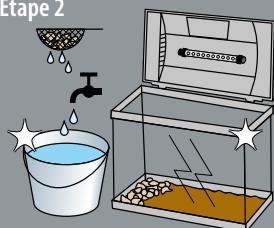
Nettoyez l'aquarium et les accessoires soigneusement à l'eau du robinet et rincez le gravier d'aquarium afin qu'il soit propre. Ne jamais utiliser de liquide ou d'alcool de nettoyage, utiliser un seau propre. Couvrir le fond avec du sol d'aquarium si possible riche en engrais pour plantes. Si vous avez de lourdes pierres à placer, le faire délicatement, voire insérez de la mousse entre le fond et les pierres : vous risquez sinon de provoquer une fissure de l'aquarium (hors garantie).
