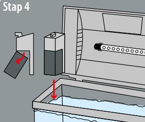
Lees eerst de Aqua-Flow gebruiksaanwijzing. Installeer het AquaFlow filter in het aquarium. Het filter zorgt ervoor dat het water gezond blijft, daarvoor moet de filtercassette wel wekelijks schoongespoeld worden. Klik de cassette van het filter en spoel deze af met schoon kraanwater. De cassette bevat kool wat schadelijke stoffen uit het water absorbeert, vervang de cassette maandelijks voor een goede werking.
